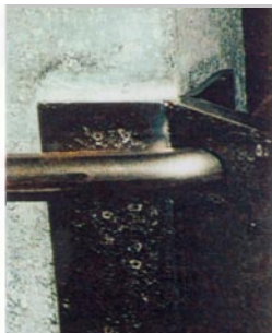
Perno y mordaza tras los ensayos de prohesión
