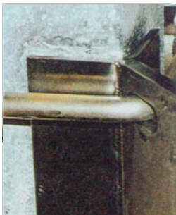
Perno y mordaza tras los ensayos de prohesión
